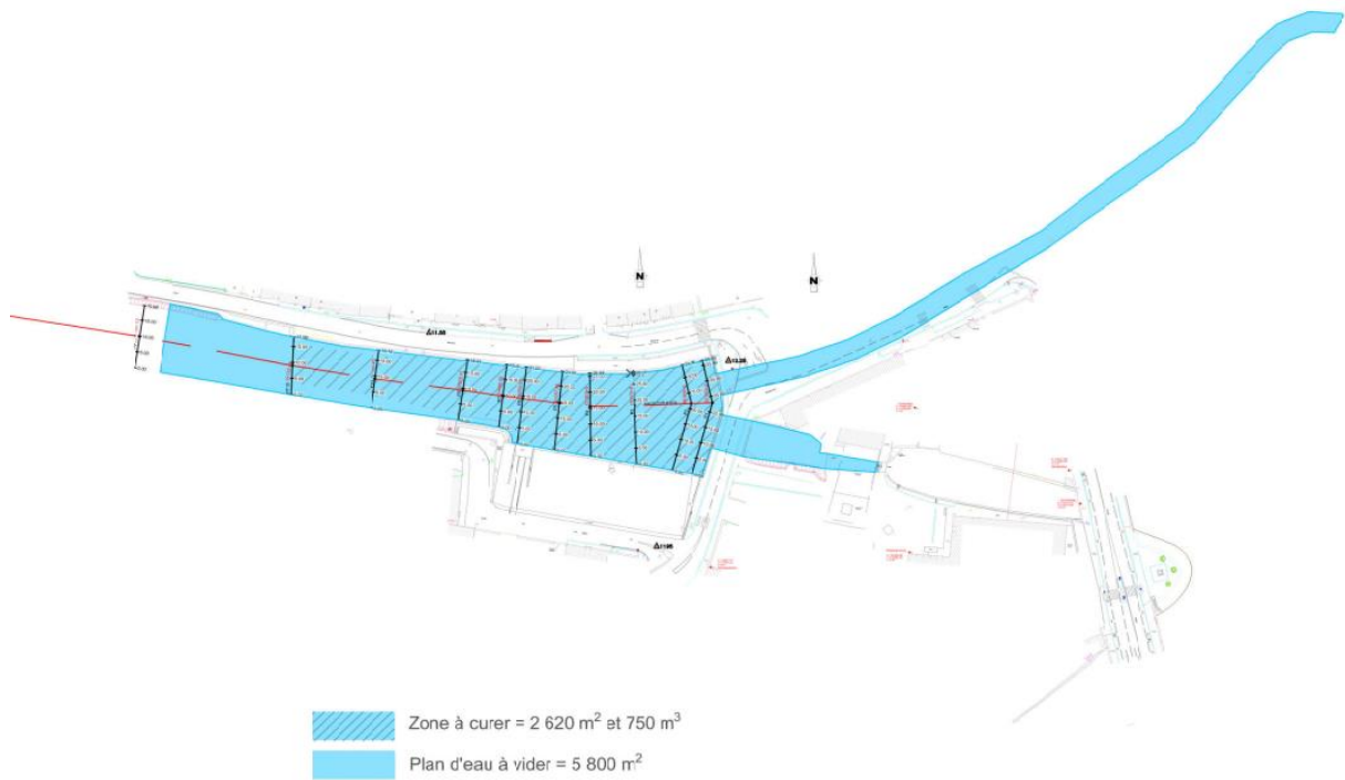
Fig.3 : tronçon fluvial mis à sec, en incluant le tunnel sous voirie en amont du port. Outre le batardeau positionné en aval, l'emprise est fermée par deux ouvrages hydrauliques en amont.
